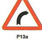
P13a Curva peligrosa hacia la derecha
