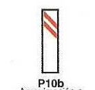
P10b Aproximación a un paso a nivel o de un puente móvil (lado izquierdo)
